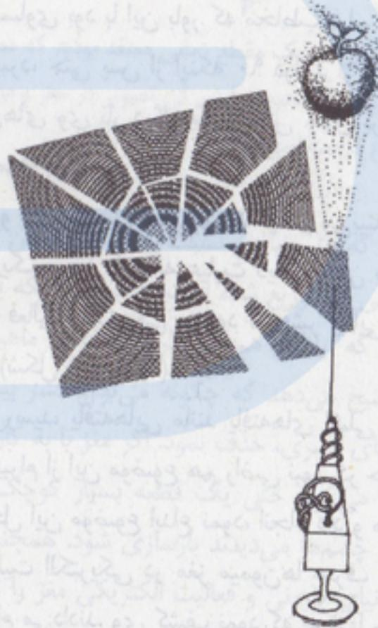
شکل ۴. برخلاف عکس‌های معمولی، هر بخش از یک قطعه فیلم هولوگرافیکی شامل تمام اطلاعات کلی است. بنابراین اگر یک صفحه هولوگرافیک به قطعات کوچکتری شکسته شود، هر قطعه همچنان می‌تواند برای بازسازی کل تصویر استفاده شود. تصویر مشاهده شده همچنین هولوگرافیک است.
